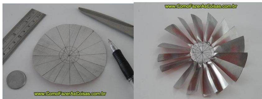
Figura 7 – Construção da hélice
