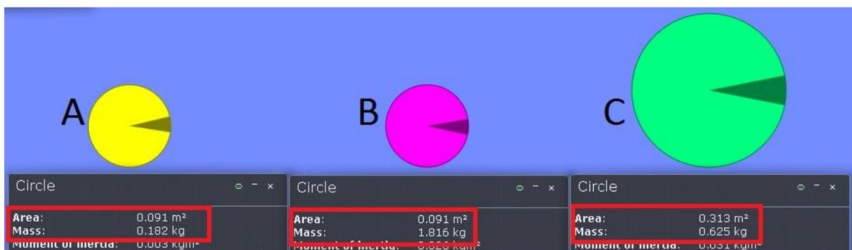
**Figura 4: Informações sobre os círculos desenhados (massa e densidade) para realização de experimento de queda livre**
