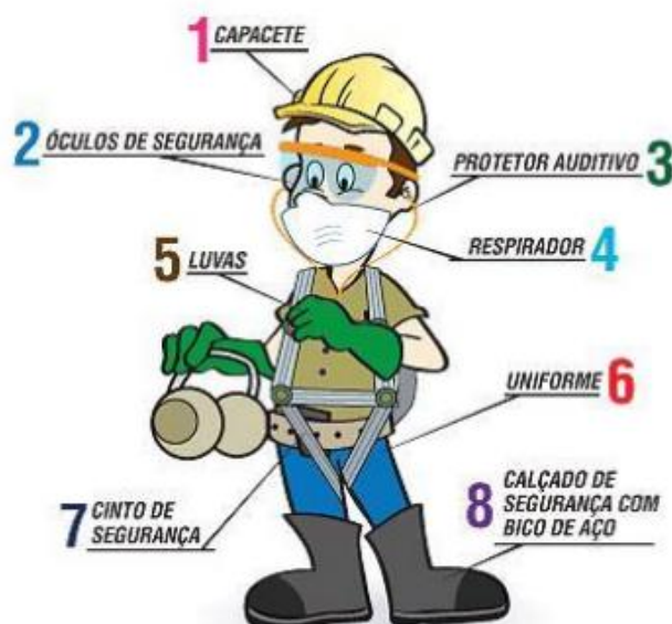
Figura 2 – Uso de Equipamentos de Proteção Individual – EPI
