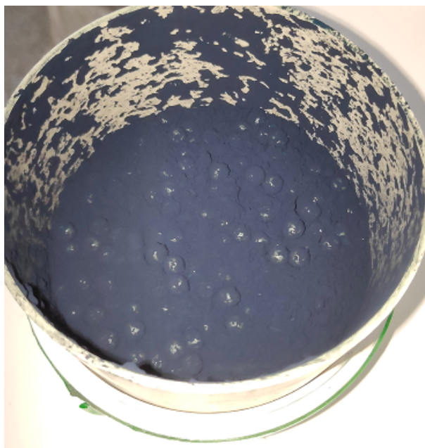
Figura 28 – Vaso do moinho de bolas após a moagem durante 8 horas de PANi com esferas de 8 mm, evidenciando a adesão de partículas às paredes.
