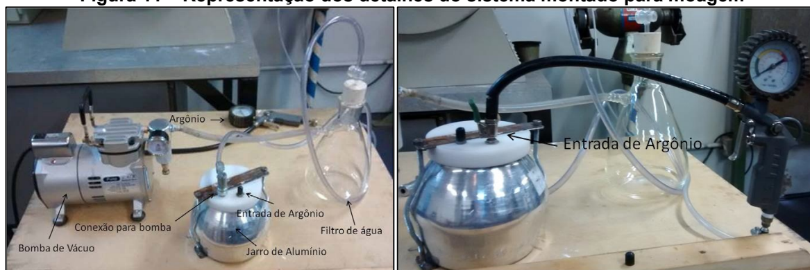
Figura 11 – Representação dos detalhes do sistema montado para moagem
