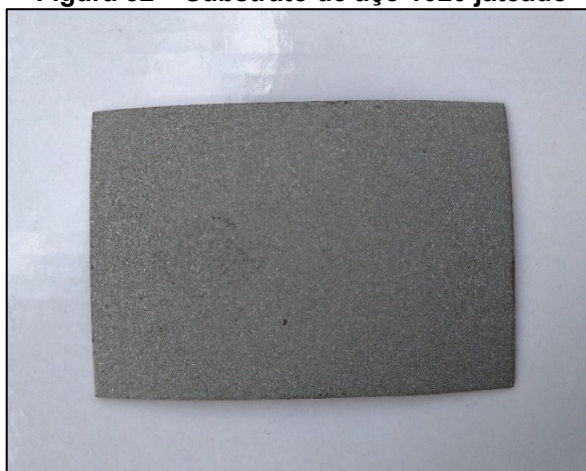
Figura 32 – Substrato de aço 1020 jateado
