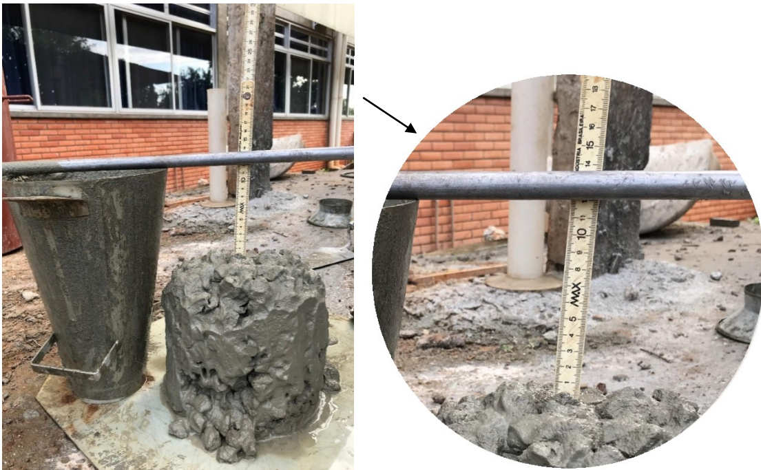
Figura 3 - Medida do abatimento concreto base
