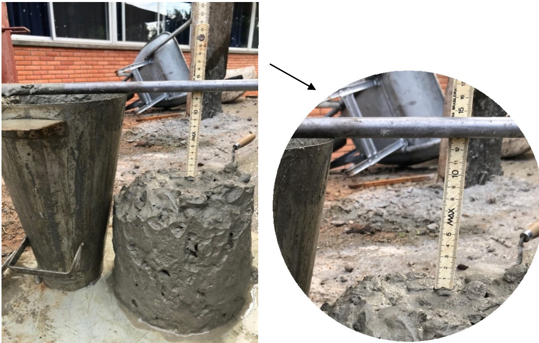
Figura 4- Medida do abatimento com aditivo “A”
