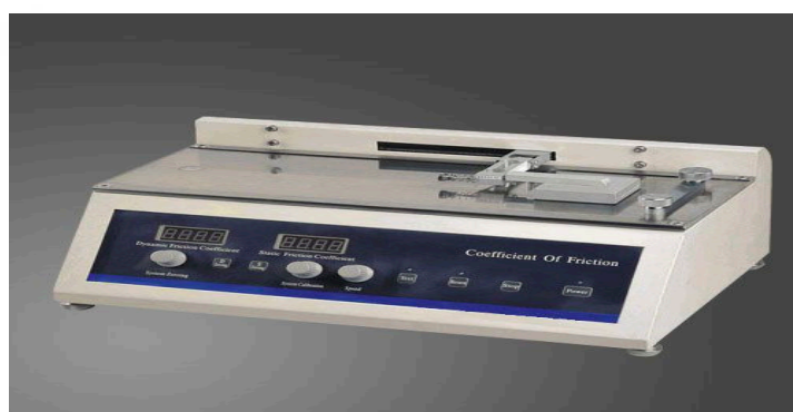
Figura 6 - Equipamento de leitura de COF
