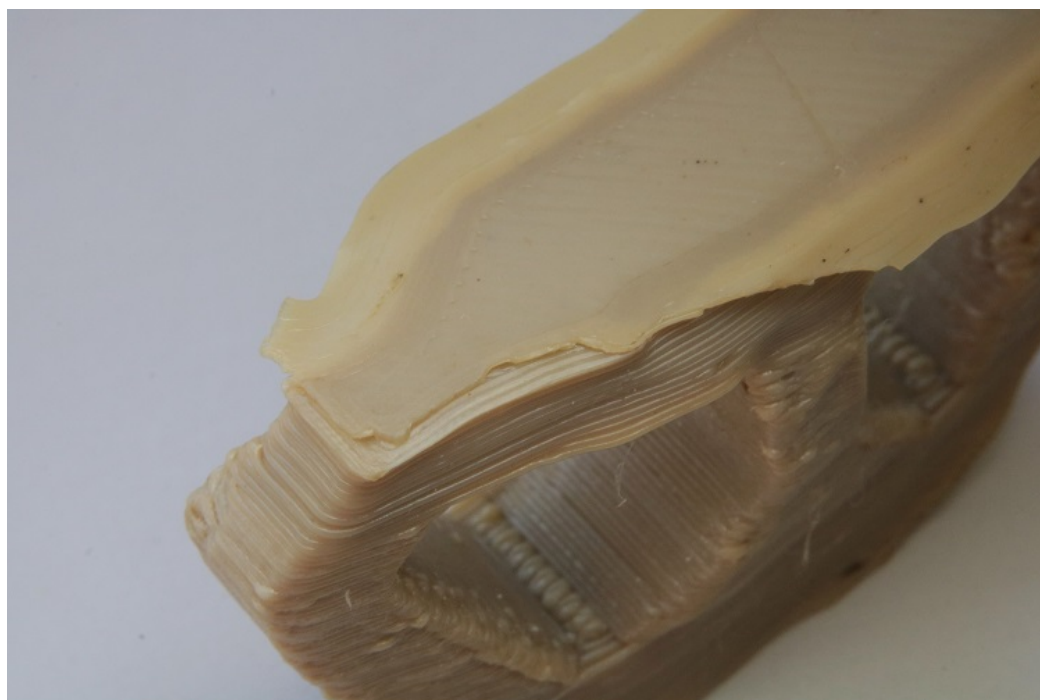
Figura 73 – Dano na primeira camada do implante na tentativa de remoção do brim sem distanciamento.
