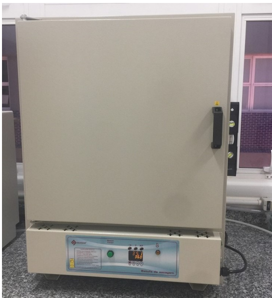
Figura 59 – Estufa de Secagem usada para retirar a umidade do filamento.
