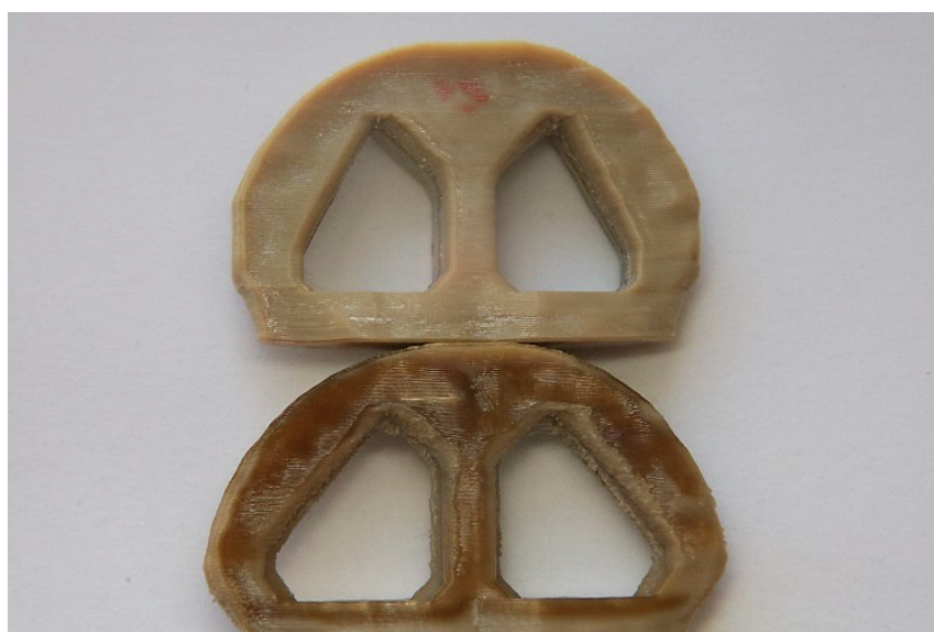
Figura 94 – Acima, protótipo após o recozimento. Abaixo, protótipo sem recozimento
