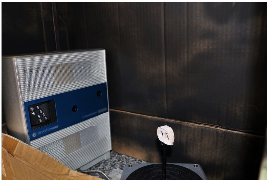
Figura 78 – Montagem para a digitalização 3D dos protótipos de implantes.
