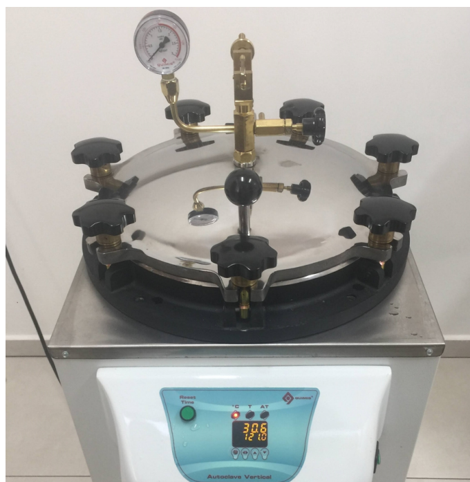
Figura 75 – Autoclave utilizada para esterilização por calor úmido.
