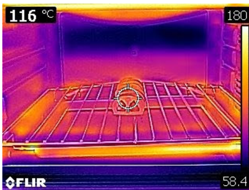
Figura 93 – Imagem térmica do processo de recozimento ( annealing ) dos protótipos de implante.
