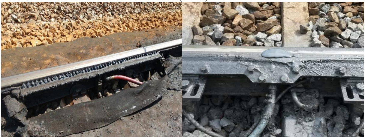
Figura 16 – Fotografia de uma barra de aplicação de graxa lubrificante (esquerda) e modificador de atrito (direita)
