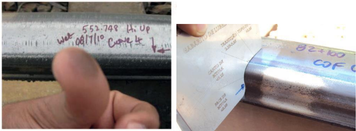
Figura 36 – Medição de carregamento da graxa através da identificação manual da graxa ao longo da ferrovia
