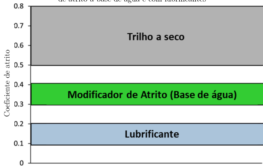
Figura 14: Coeficiente de atrito típicos encontrados para trilho em condições a seco, com modificadores de atrito a base de água e com lubrificantes
