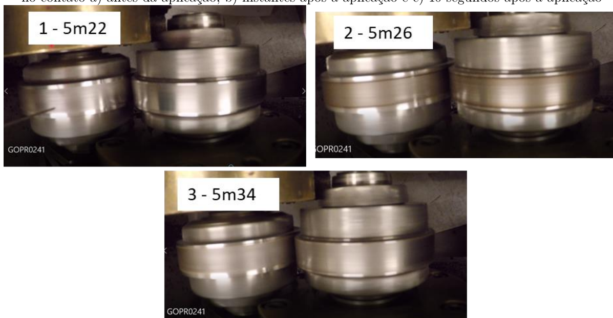
Figura 102: Sequência de fotografia da superfície dos discos durante a aplicação de uma gota de água no contato a) antes da aplicação, b) instantes após a aplicação e c) 10 segundos após a aplicação
