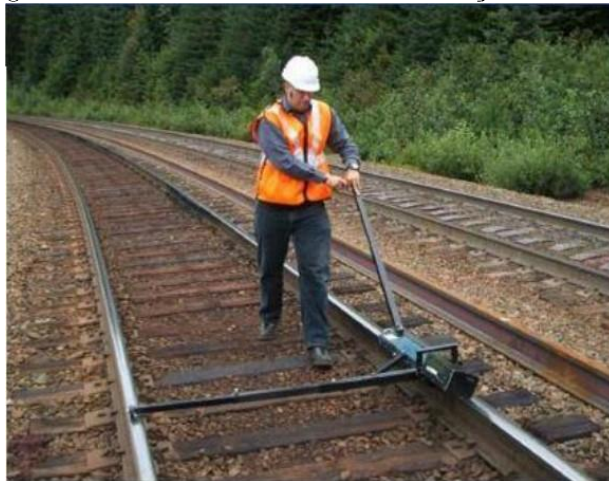
Figura 35 - Tribômetro manual em utilização ferroviária
