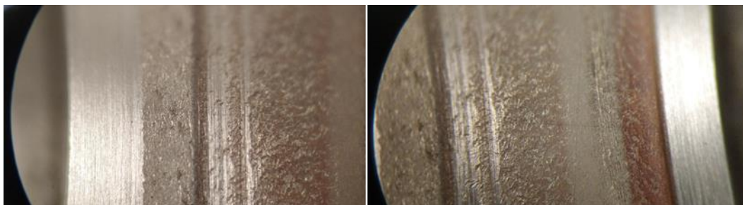
Figura 100: Fotografia da superfície do disco após o ensaio de retentividade com o modificador de atrito a base de água
