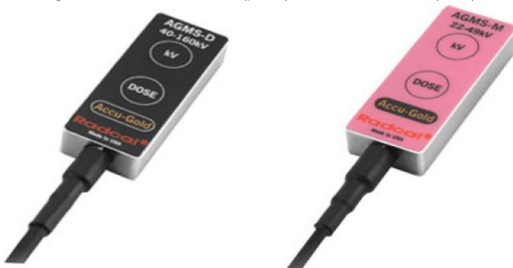
Figura 7 - Sensor AGMS-D (preto) e sensor AGMS-M (rosa).
