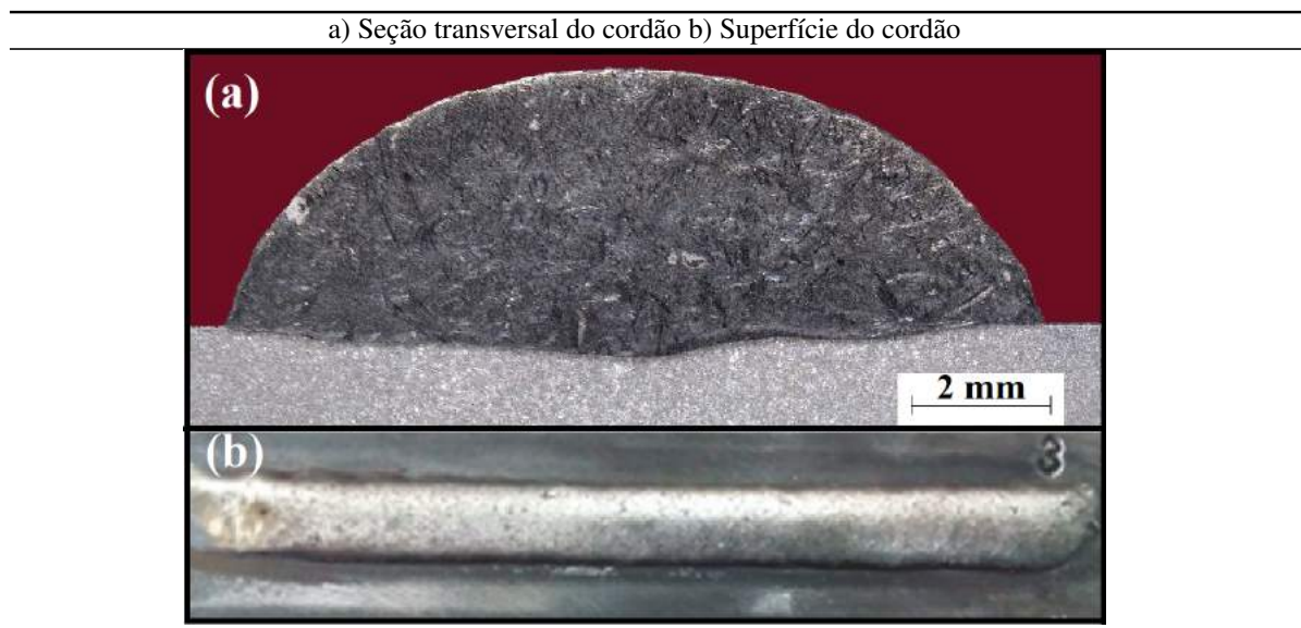
Figura 125 – Detalhe na seção transversal do cordão mostrando um cordão, da condição n° 13, com características para a formação de revestimentos.
