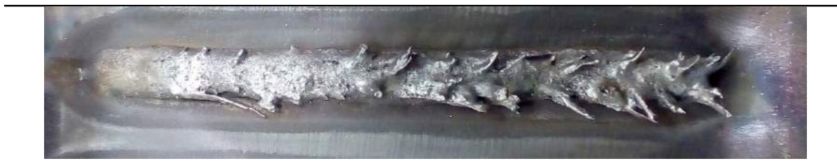
Figura 123 – Aspecto superficial de um cordão, da condição n° 3, que apresentou falta de fusão do arame.
