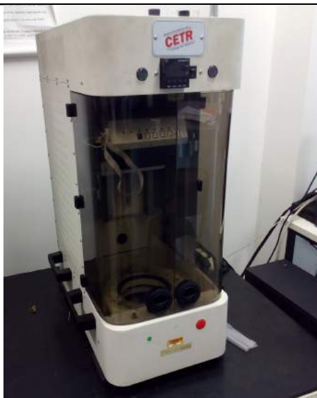
Figura 60 – Equipamento utilizado para a caracterização dos mecanismos de abrasão dos revestimentos por riscamento.
