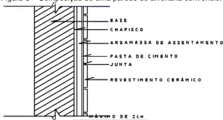
Figura 3 – Composição de uma parede de alvenaria convencional
