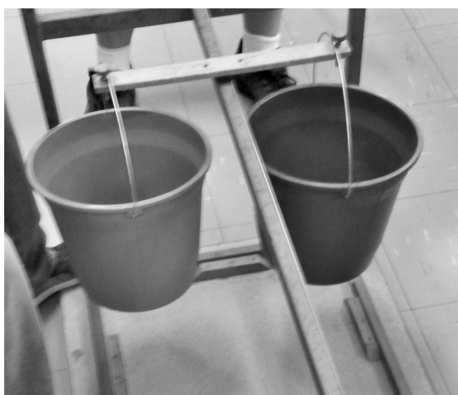
Figura 6: Exemplo simples e funcional de balança de baldes pensada e montada por estudantes num curso de extensão realizado na UEPG em 2015.
