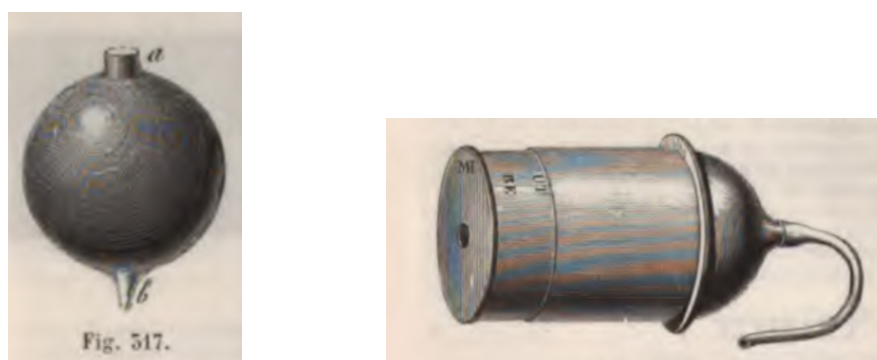
Figura 7: ressonadores (que evidenciam uma frequência) de Helmholtz (esquerda) e de Koenig (direita) que tem a frequência de ressonância ajustada através da junta telescópica.
