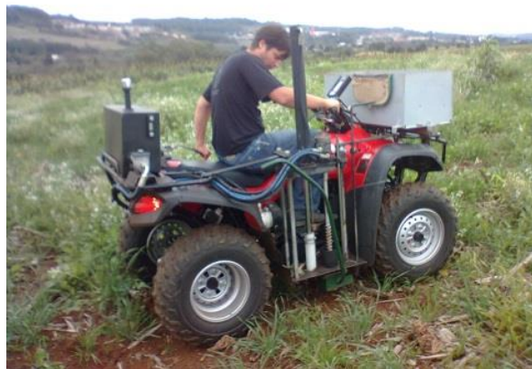
Figura 3. Quadriciclo acoplado com amostrador de solo com trado de rosca utilizado na amostragem de solo.
