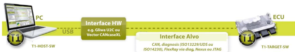
Figura 12 – Conexão entre o PC executando o módulo principal T1 e o dispositivo alvo (ECU) executando o módulo alvo T1
