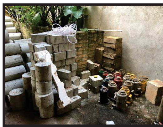
(b) macacos hidráulicos e peças de concreto.
