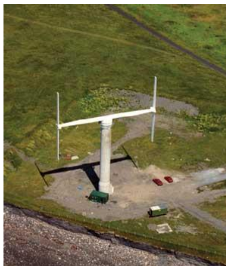
Figura 3.5 – Turbina de eixo vertical do tipo rotor H, em Carmathen, País de Gales Fonte: Tong (2010)
