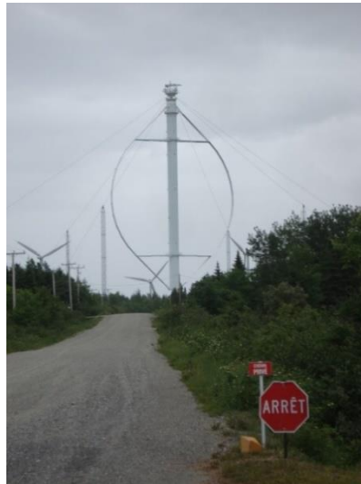
Figura 3.4 – Éole , a maior turbina de eixo vertical do mundo, em Cap-Chat, Quebec, Canadá Fonte: Éolecapchat
