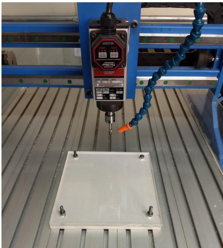
Figura 17 - Fixação do corpo de prova.
