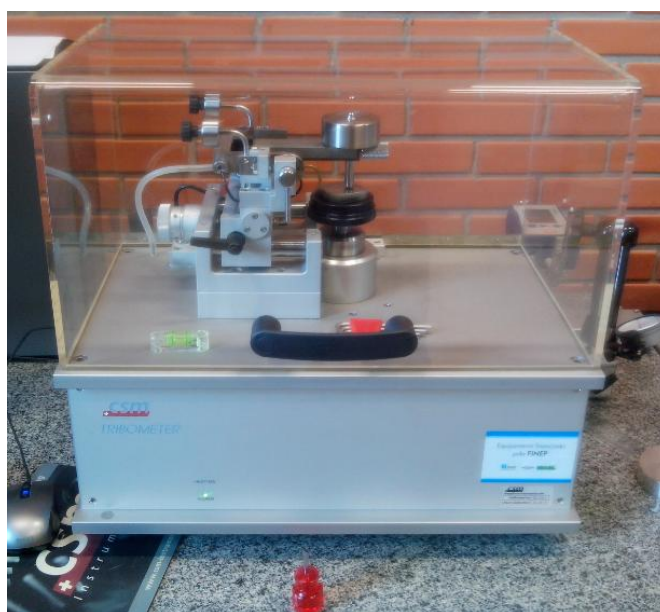
Fotografia 3 – Tribômetro utilizado no ensaio de desgaste
