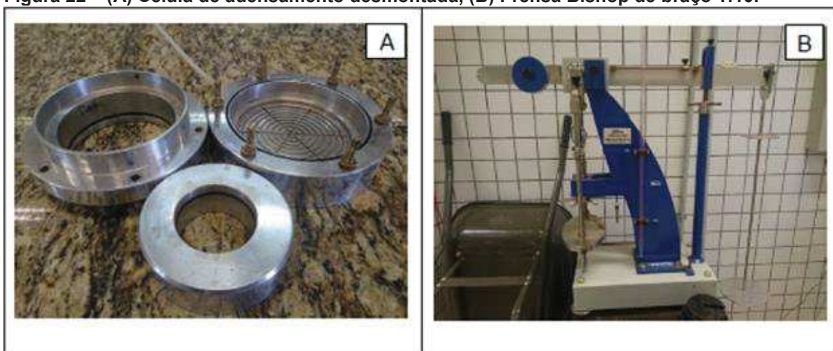
Figura 22 – (A) Célula de adensamento desmontada, (B) Prensa Bishop de braço 1:10.
