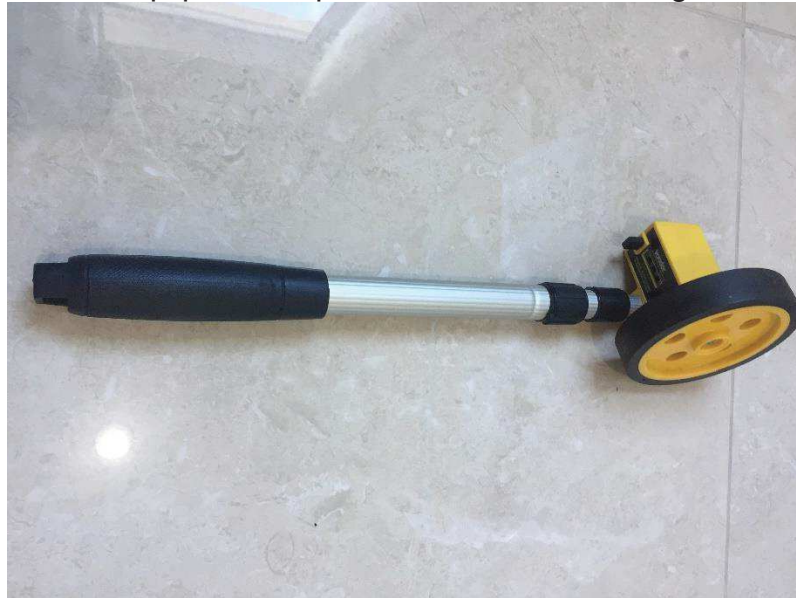
Figura 20 – Equipamento para medida, trena analógica de rodas
