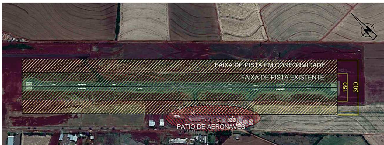
Figura 94- Faixa de pista existente e em conformidade.
