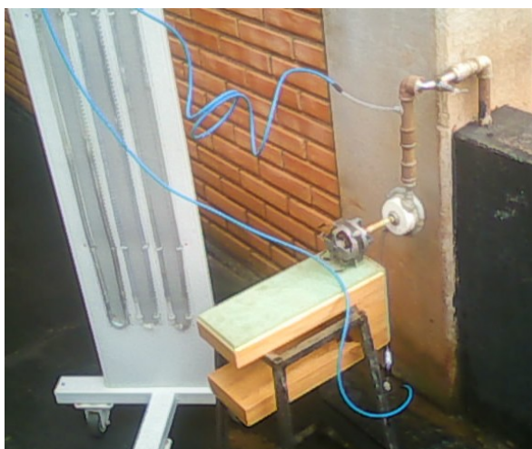
Figura 23 - Esquema do ensaio de perda de carga.
