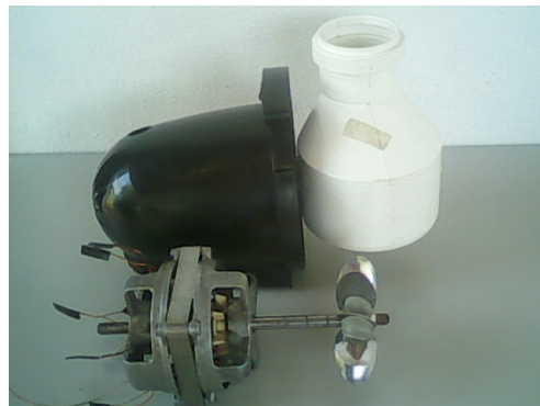
Figura 7 - Carcaça e proteção do gerador.
