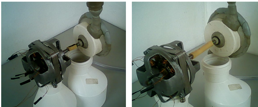
Figura 18 – Ligação entre gerador e turbina com conexão flexível.
