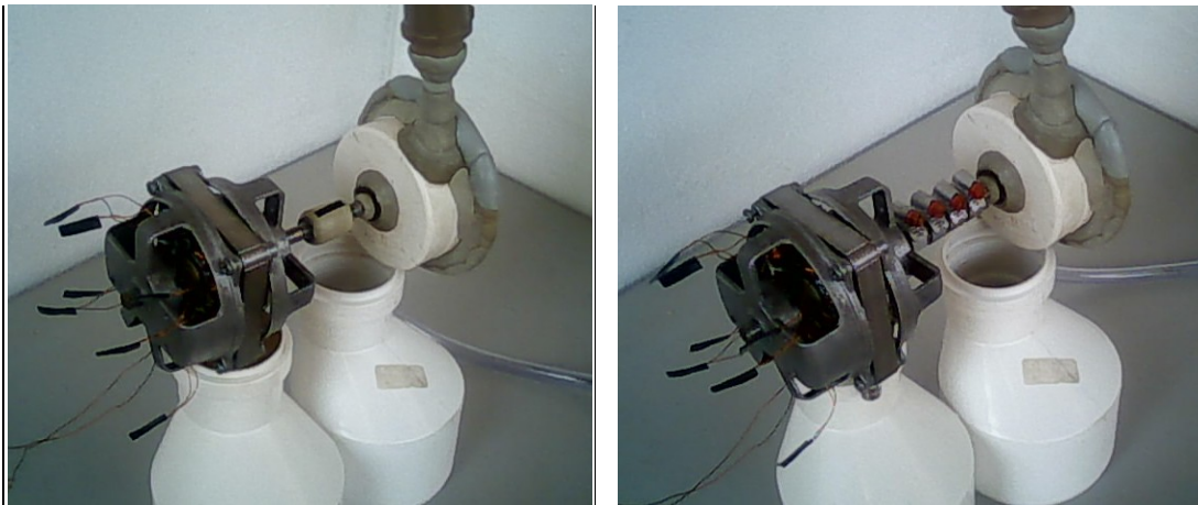
Figura 17 – Ligação entre gerador e turbina com conexão rígida.
