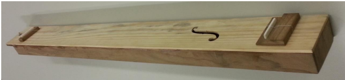
Figura 4 – A caixa de ressonância do monocórdio em madeira de Cabreúva de Alta densidade em corte radial. Fonte: Do autor
