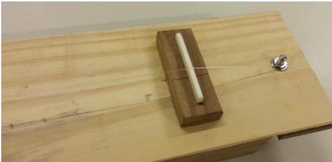
Figura 6 – Monocórdio em detalhe: Tarraxa de afinação e cavalete superior com rastilho Fonte: Do autor
