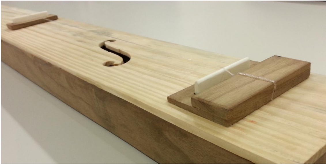
Figura 5 – Monocórdio em detalhe: o cavalete inferior com Rastilho e boca da caixa de ressonância. Fonte: Do autor
