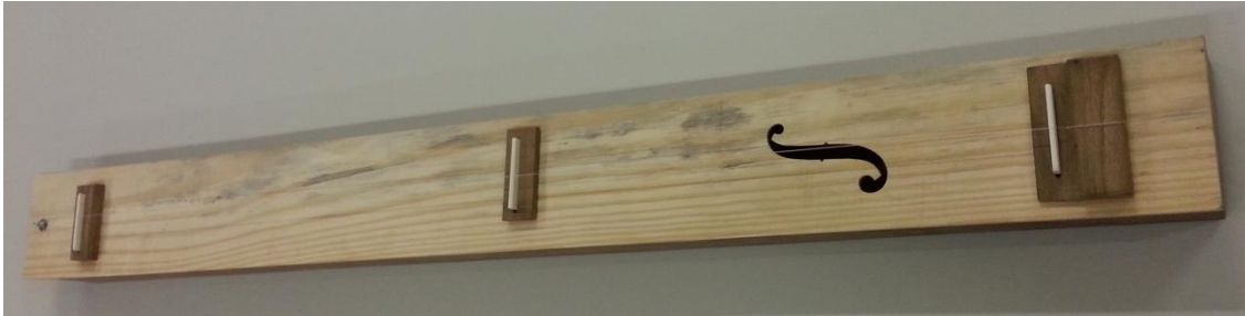
Figura 3 - O Monocórdio de Pitágoras com tampo em Pinus de baixa densidade em corte radial Fonte: Do autor
