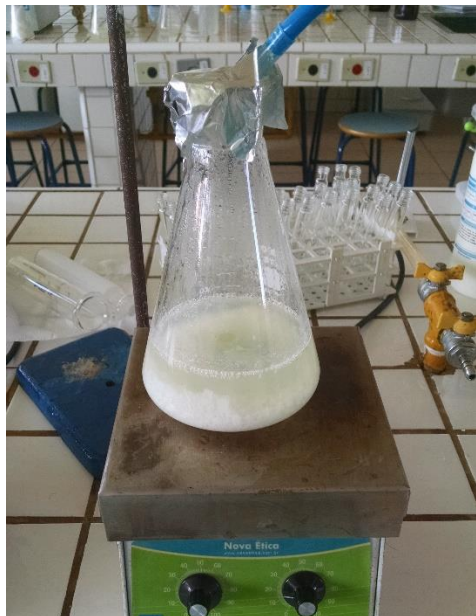
Figura 3 Soro resfriando sob atmosfera de CO 2 .
