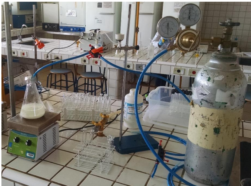
Figura 2 Parte do aparato para obtenção da cultura anaeróbica.
