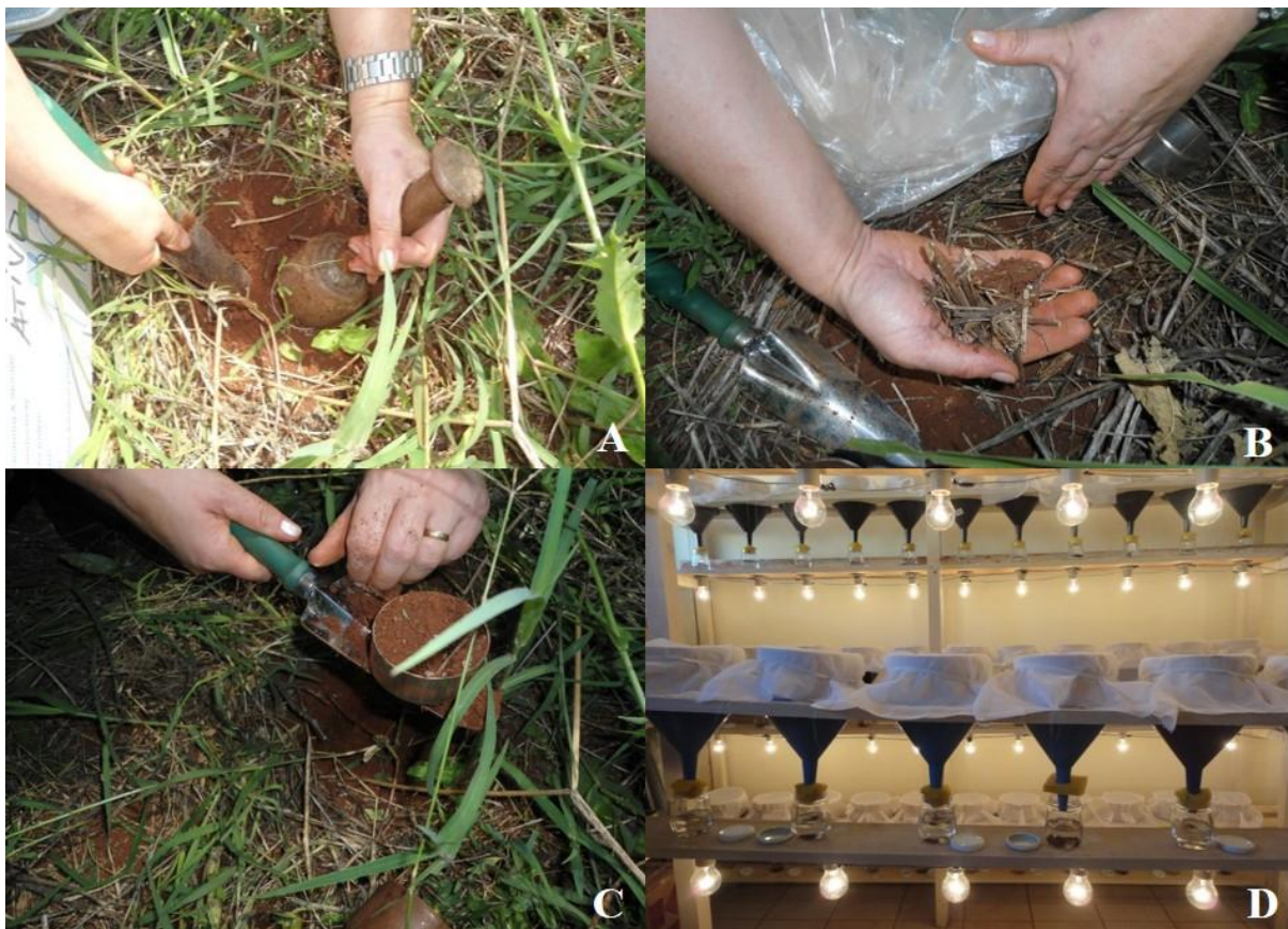
Figura 7 – Metodologia de coleta Berlese-Tüllgren: a- uso de anel e de coletor de amostra indeformada para a coleta de solo; b- amostra coletada de solo; c- coleta da serapilheira; d- funis de Berlese-Tüllgren. UTFPR, Câmpus Pato Branco-PR, Brasil, 2017.
