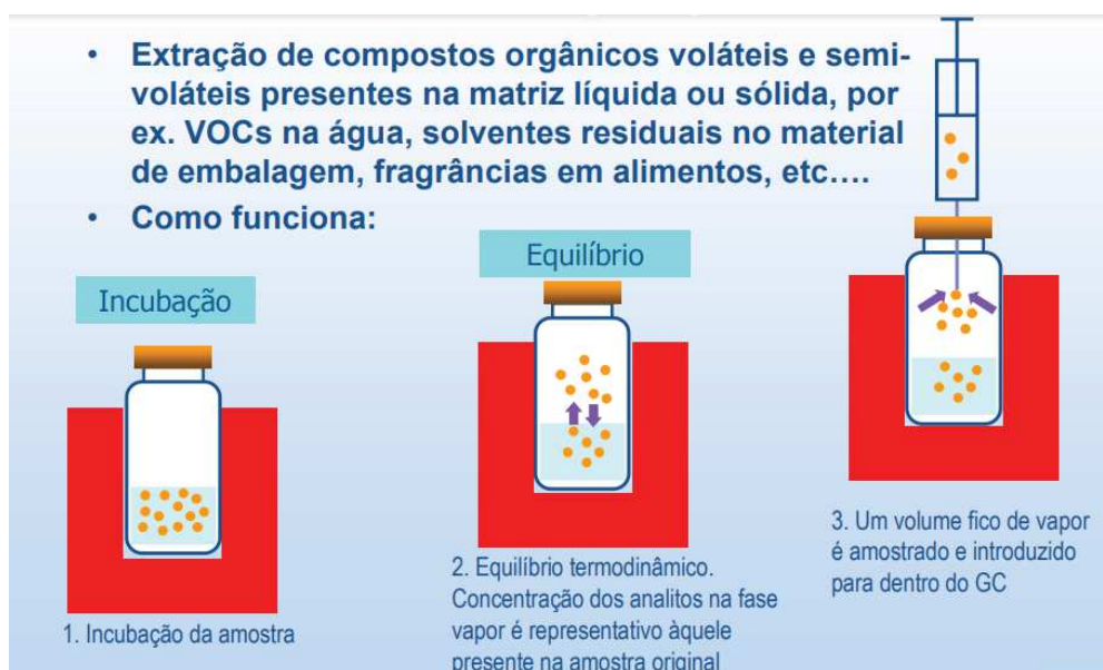
Figura 4 - Desenho esquemático processo amostragem da técnica headspace .
