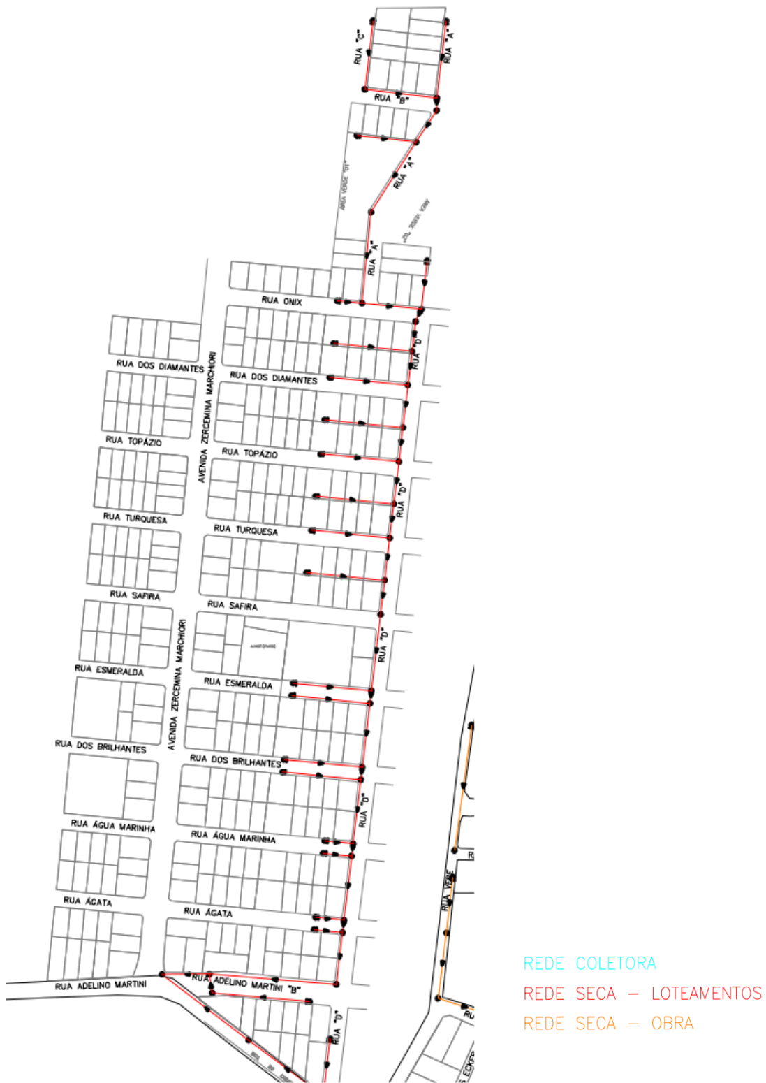
Figura 33 - Rede coletora de esgoto no Loteamento Marchiori Fonte: Dados fornecidos pela PMFB. (Editado pela autora)
