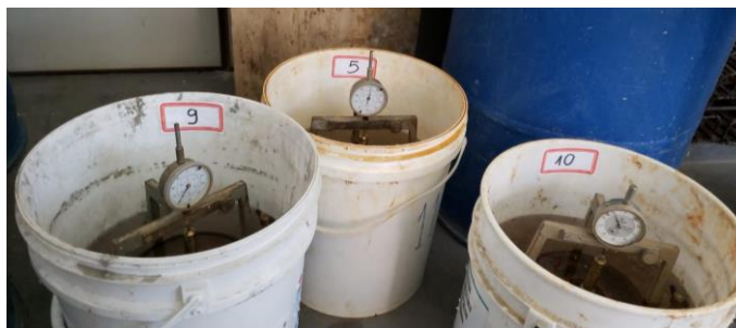
Figura 11 - Corpos de prova imersos em água para o ensaio de expansão
