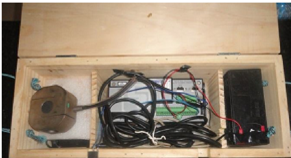
Figura 24 – Sistema de aquisição de dados, modelo CR800, utilizado durante a semeadura da soja.
