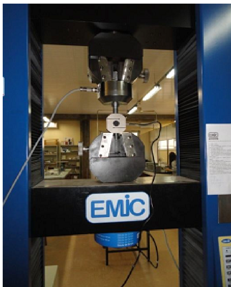
Figura 26 – Ensaio para calibração da célula de carga utilizada no experimento, realizado pela UTFPR, Pato Branco – PR, 2015.
