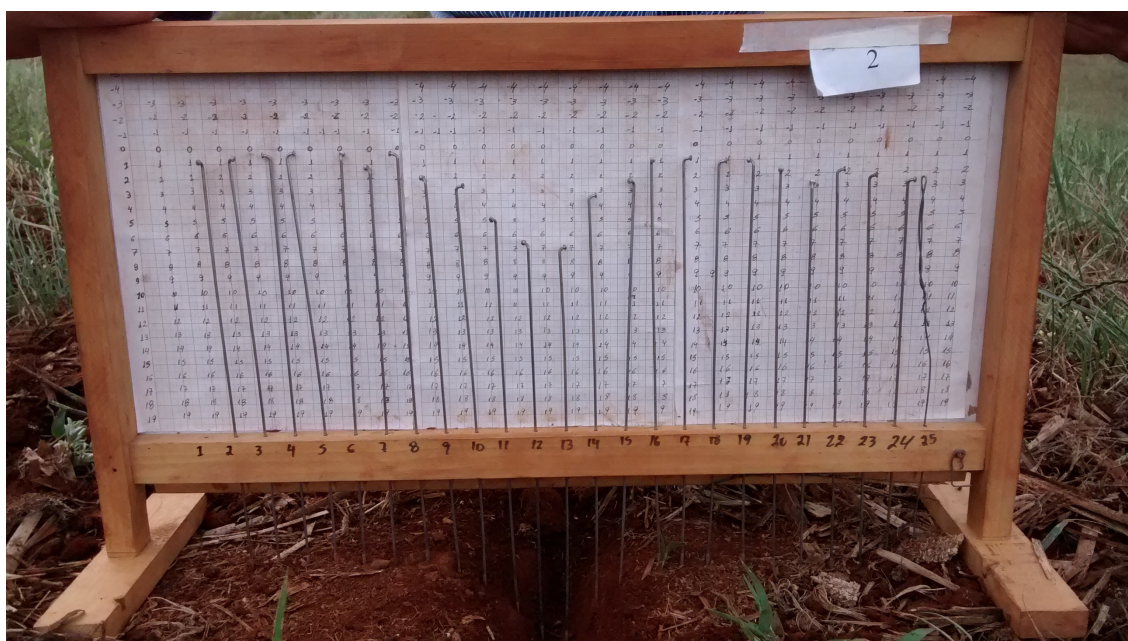
Figura 22 – Vista geral do perfilômetro de madeira utilizado para avaliação da profundidade, largura de sulco e da área de solo mobilizado.
