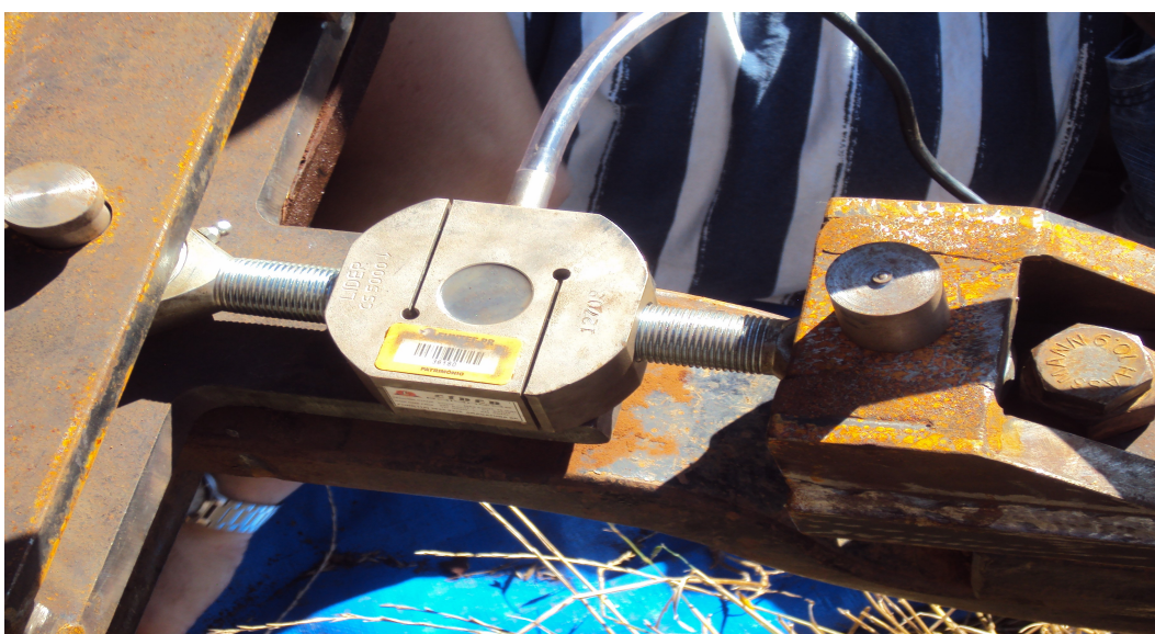
Figura 25 – Vista geral da célula de carga inserida entre o trator e a semeadora – adubadora.
