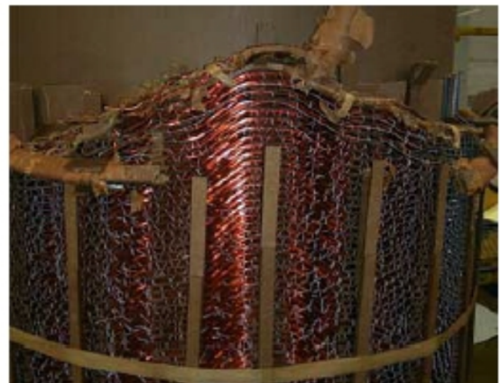
Figura 7 – (a) Comparação da varredura em resposta em frequência em um das fases de um transformador de 60 MVA, 400 kV, antes e depois de uma falha catastrófica de curto-circuito. (b) Foto da falha ocorrida e que danificou completamente o transformador
