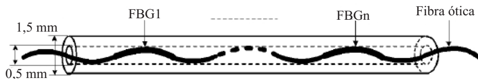
Figura 23 – Tubo capilar de aço inoxidável usado no encapsulamentos dos sensores FBG, dentro de uma barra do estator de um gerador de potência
