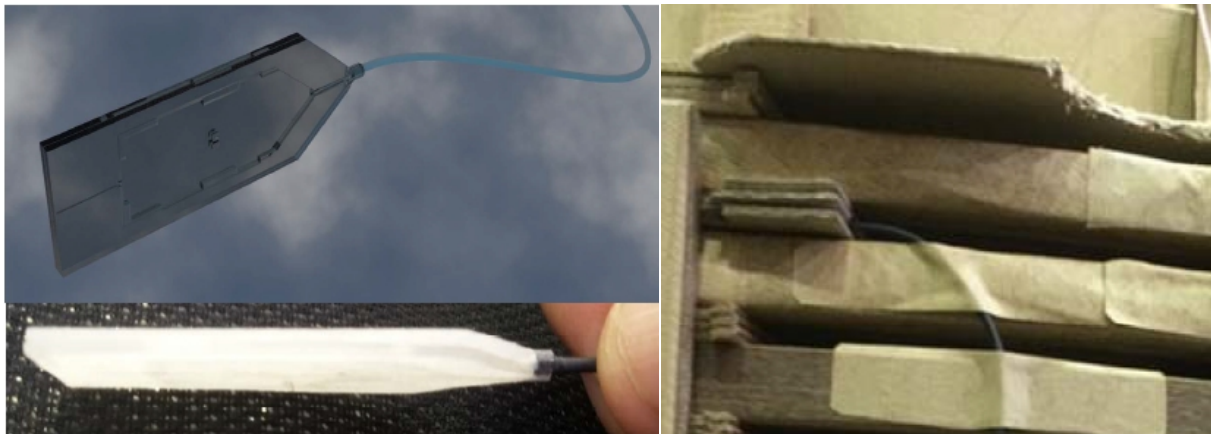
Figura 17 – Sensor projetado em um filme fino de polímero e posicionamento em partes dos enrolamentos de um transformador de 110 kV
