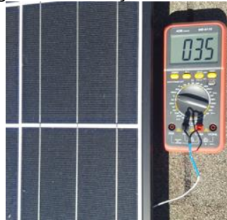
Figura 55 - Medição da Tc no EV
