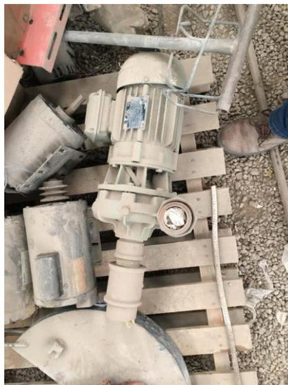
A moto bomba possui a seguinte vazão 16m<sup>3</sup>/h, diâmetros de sucção 1.1/2" e recalque 1".
