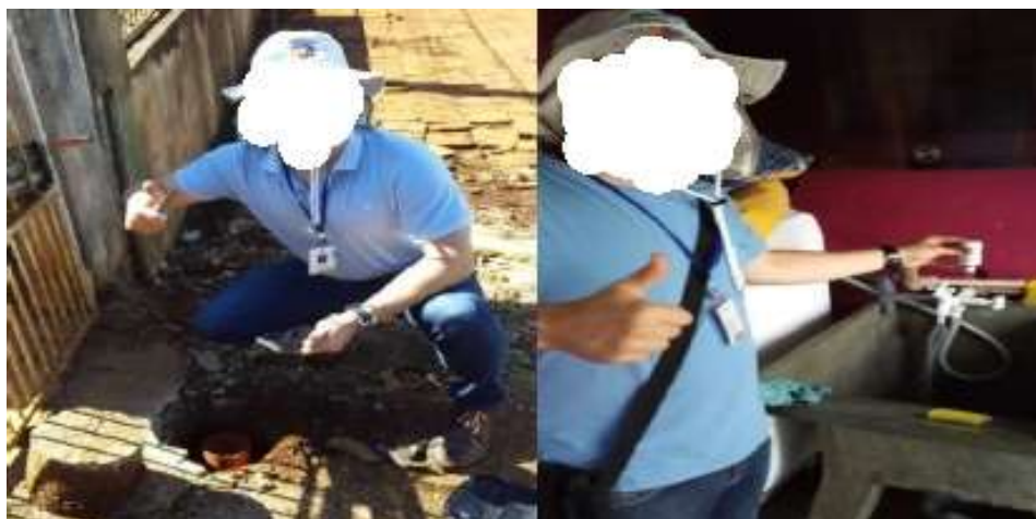
Figura 38. Verificação do DTI e aplicação de corantes em vistoria.
