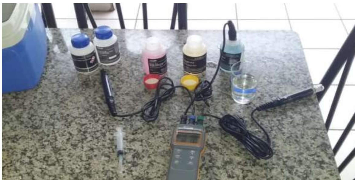
Figura 19. Calibração do medidor AK88, em dia anterior ao monitoramento.
