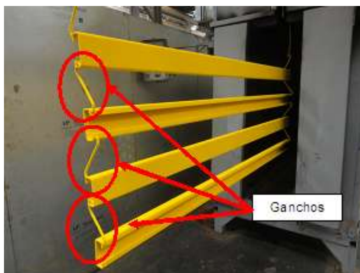
Figura 21 - Fixação das peças Perfil C sem reprojeto Fonte: Autoria própria
