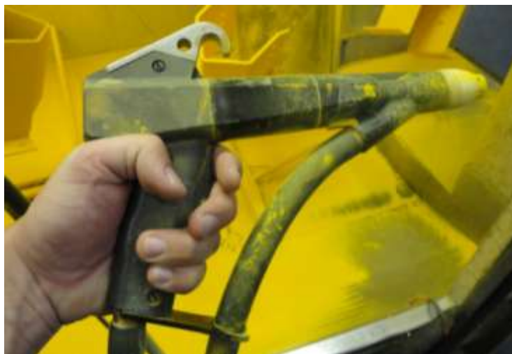
Figura 18 - Pistola aplicadora de tinta em pó Fonte: Autoria própria
