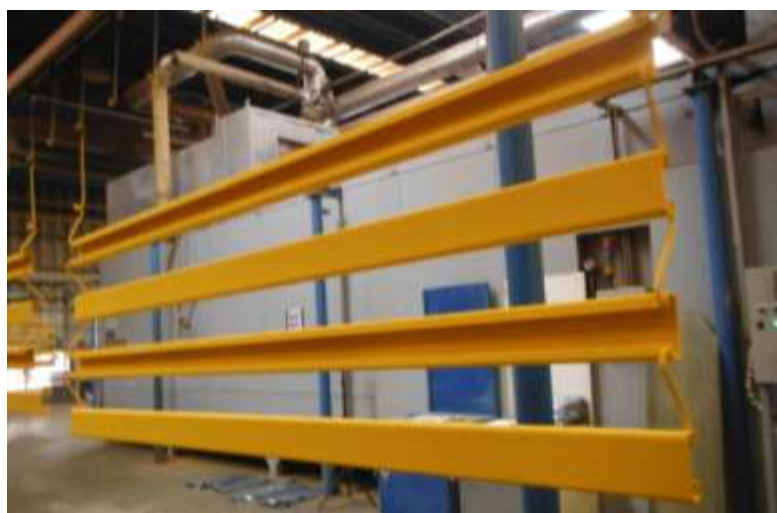
Figura 17 - Forma de transporte e fixação das peças Perfil C Fonte: Autoria própria
