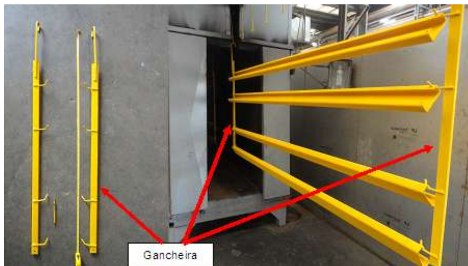
Figura 22 - Gancheiras e o novo projeto de fixação das peças Perfil C Fonte: Autoria própria
