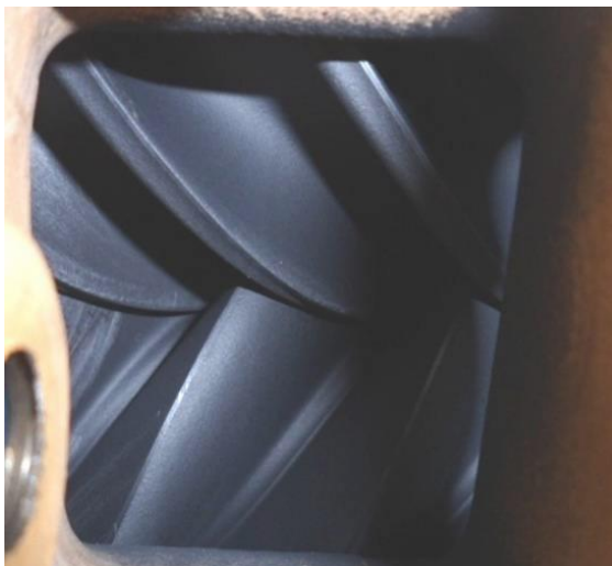
Figura 7 - Unidade compressora de um compressor de parafusos. Fonte: O autor.
