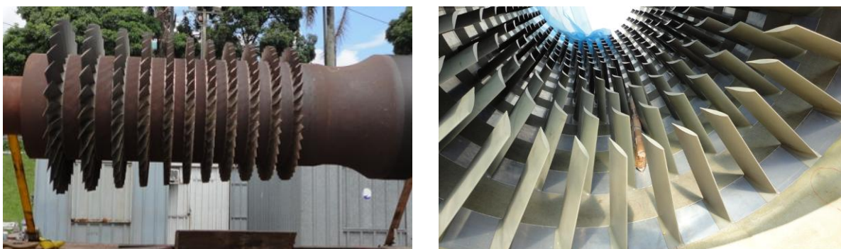
Figura 5 - Rotor e estator de um compressor axial.
