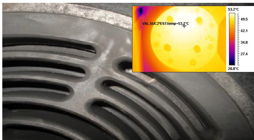
Figura 15 - Foto de uma válvula quebrada, após desmontagem, e acima o termograma indicando que ela estava aquecida.
