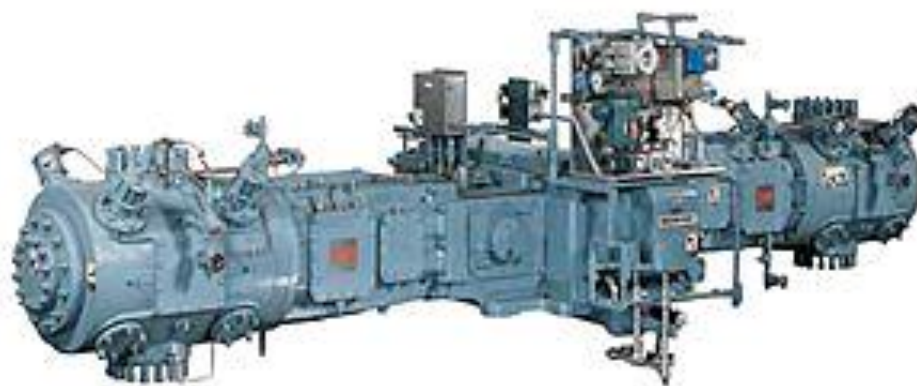
Figura 9 – Compressor alternativo horizontal de dois cilindros opostos. Fonte: Dresser-rand
