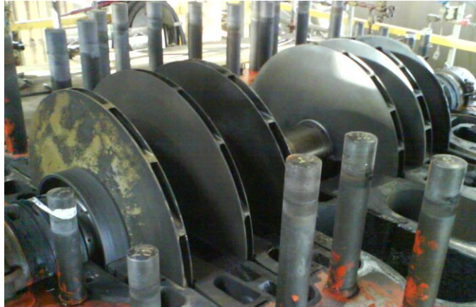
Figura 6 - Compressor centrífugo. Fonte: O autor.
