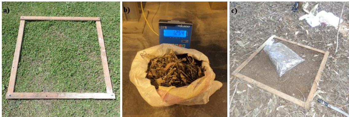
Figura 5 – Gabarito utilizado para amostragem do material combustível (a), pesagem do material combustível (b) e coleta para amostragem do material combustível (c)
