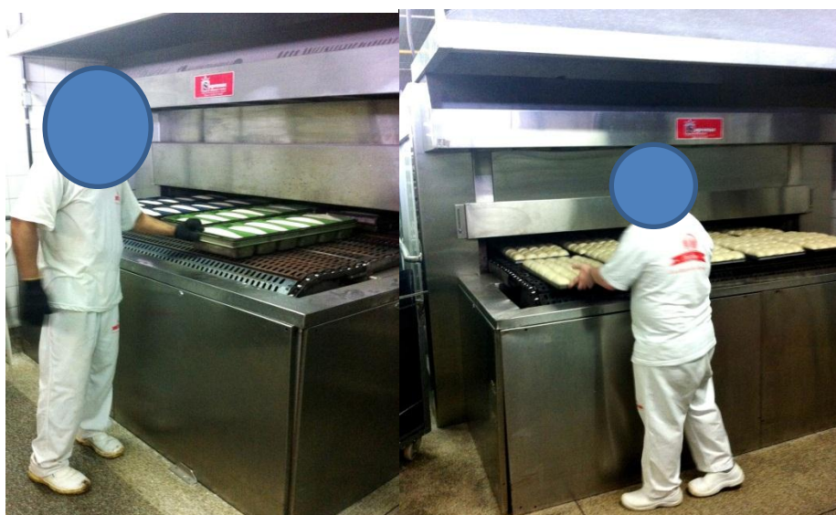
Figura 8 - Entrada dos pães nos fornos esteira
