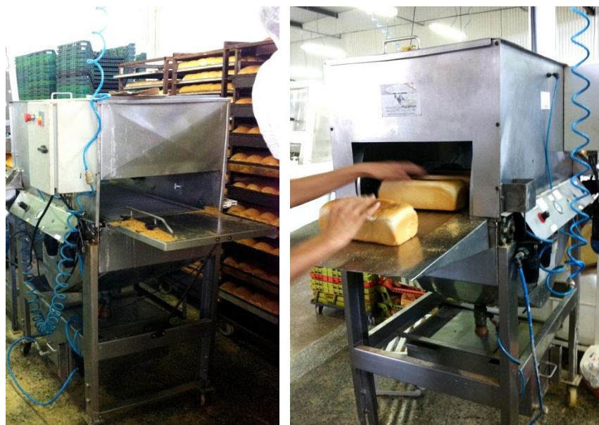
Figura 2 - entrada do pão no pulverizador de shelf life da embaladora automática e semiautomática
