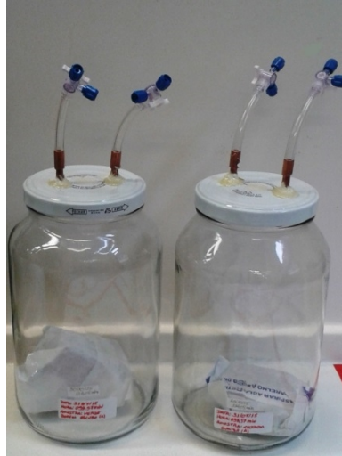
Figura 26 - Amostras de granitos lacradas em frascos de vidro.
