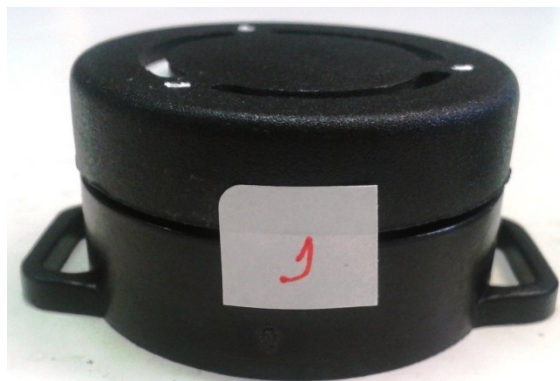
Figura 22 - Câmara de difusão numerada para a instalação.
