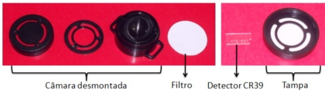
Figura 19 - Conjunto de detecção utilizado para medidas de ambientes indoor .
