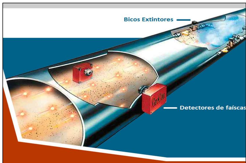
**Figura 31: Sistema de detecção e extinção de faíscas – GreCon.**
