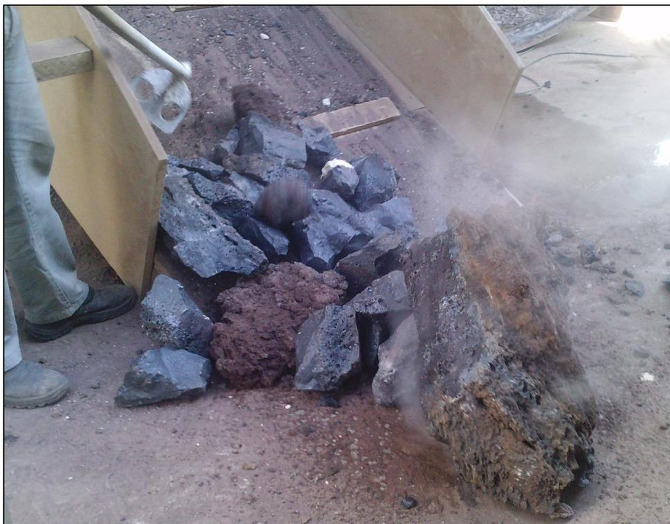
**Figura 33: Material aderido ao queimador da planta térmica, retirado com auxílio de britadeira.**
