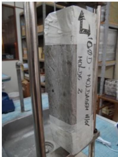
(c) Leitura dos corpos de prova embalados e com fita adesiva nas extremidades.
