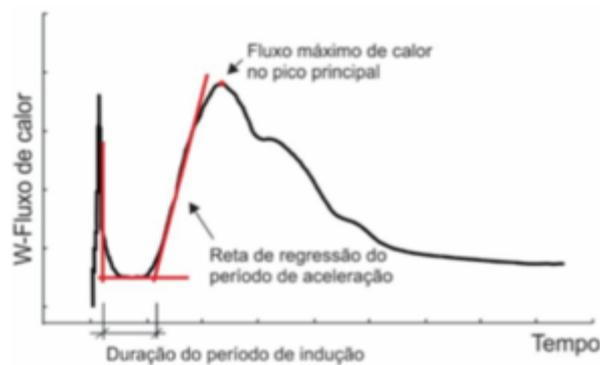
Figura 30: Representação esquemática de curva de fluxo de calor de hidratação e critérios de determinação das variáveis.
