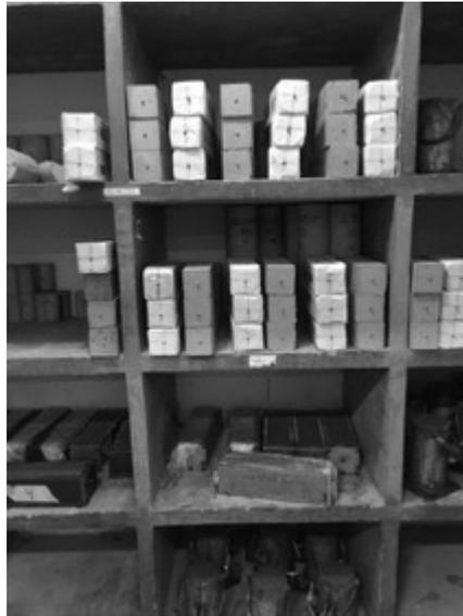
Figura 27: Corpos prova armazenados em câmara com temperatura controlada
