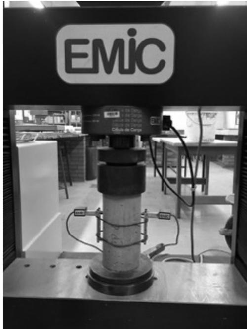
Figura 31: Ensaio do módulo de elasticidade EMIC DL-3000.
