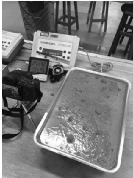
Figura 28: Aparato para análise da perda de água no estado plástico.
