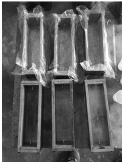
Figura 26: Corpos de prova prismáticos para ensaio de retração.
