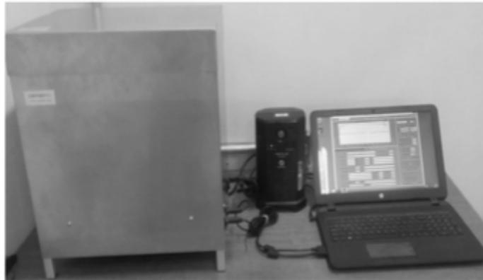
Figura 29: Calorímetro Calmetrix I-Cal 2000 HPC.
