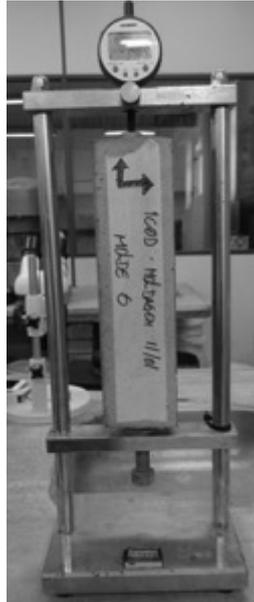
Figura 33: Comparador mecânico vertical.
