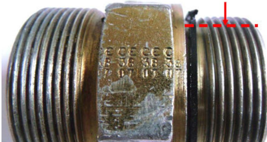
Figura 17 – Detalhe da identificação do componente. Em vermelho, local do corte para análise metalográfica.
