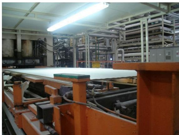
**Figura 06: Introdução de placas na prensa**
