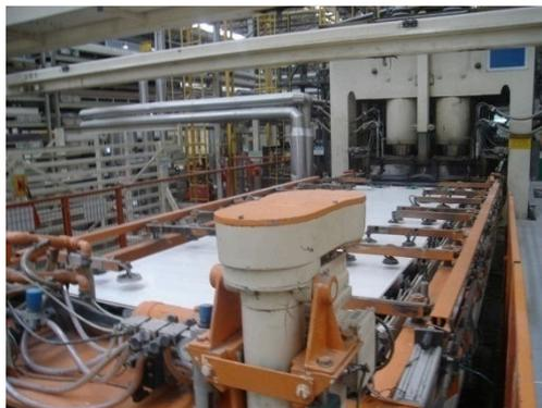
**Figura 08: Retirada de placas da prensa**
