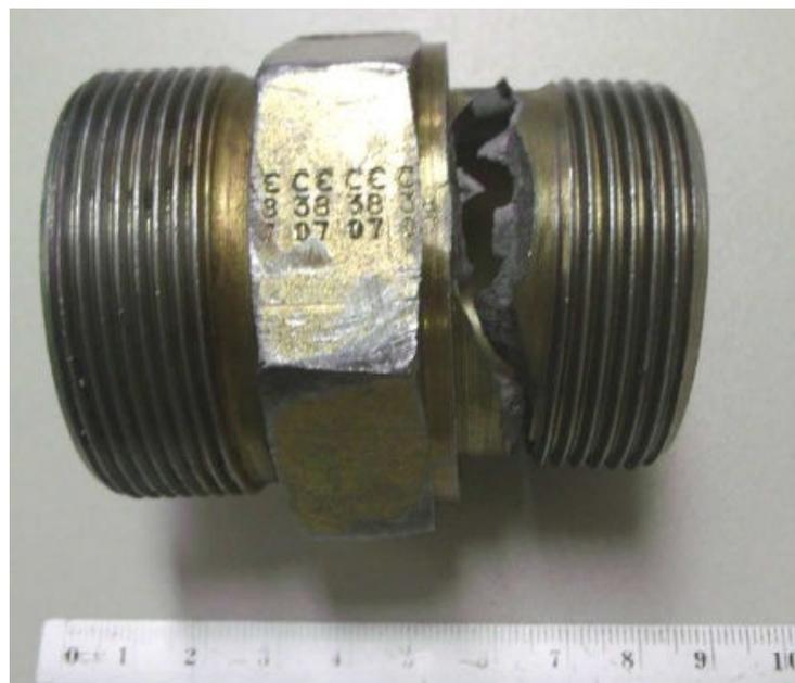
**Figura 15 – Niple de redução quebrado**
