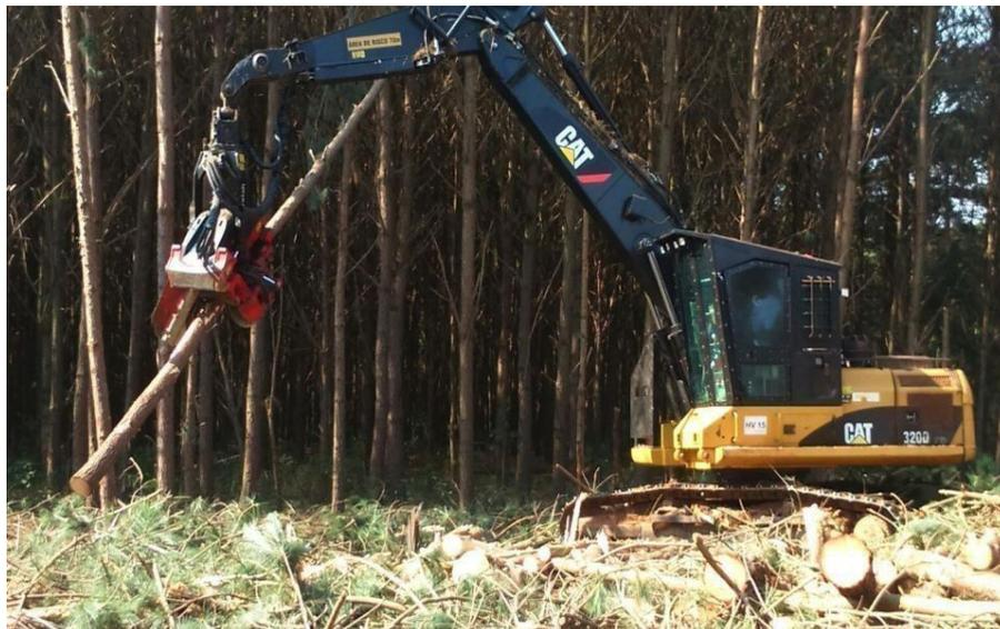
Figura 8 - *Harvester* CAT 320 d utilizado neste estudo.
