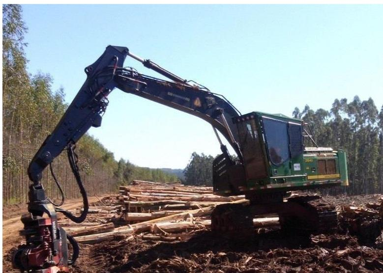
Figura 7 – *Harvester JOHN DEERE 2154 D* utilizado neste trabalho.
