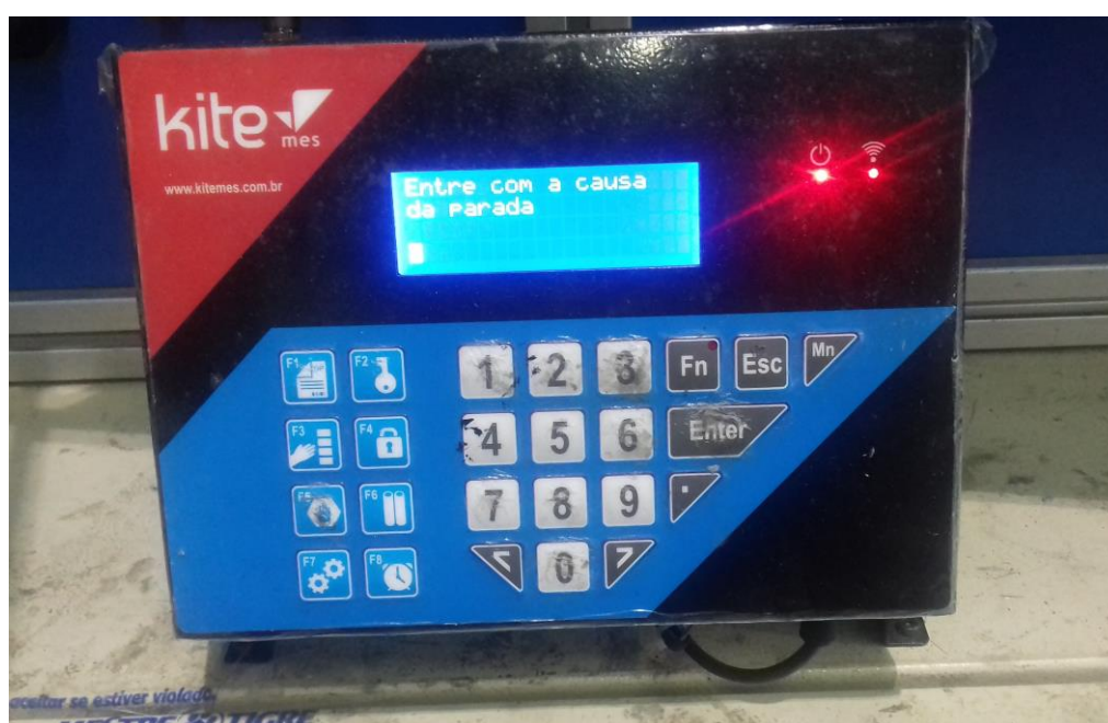
Fotografia 1 - Aparelho Kite MES® aguardando entrada de causa de parada Fonte: Autoria própria
