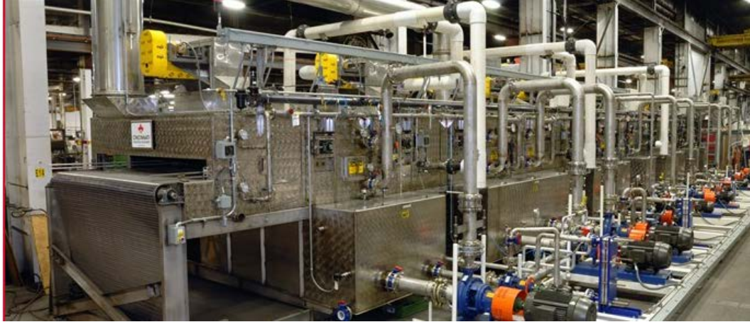
Figura 4 – Máquina de lavagem e secagem das latas de alumínio. Fonte: Cincinnati Industrial Machinery (2016)
