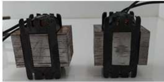
Núcleo de transformador separado
