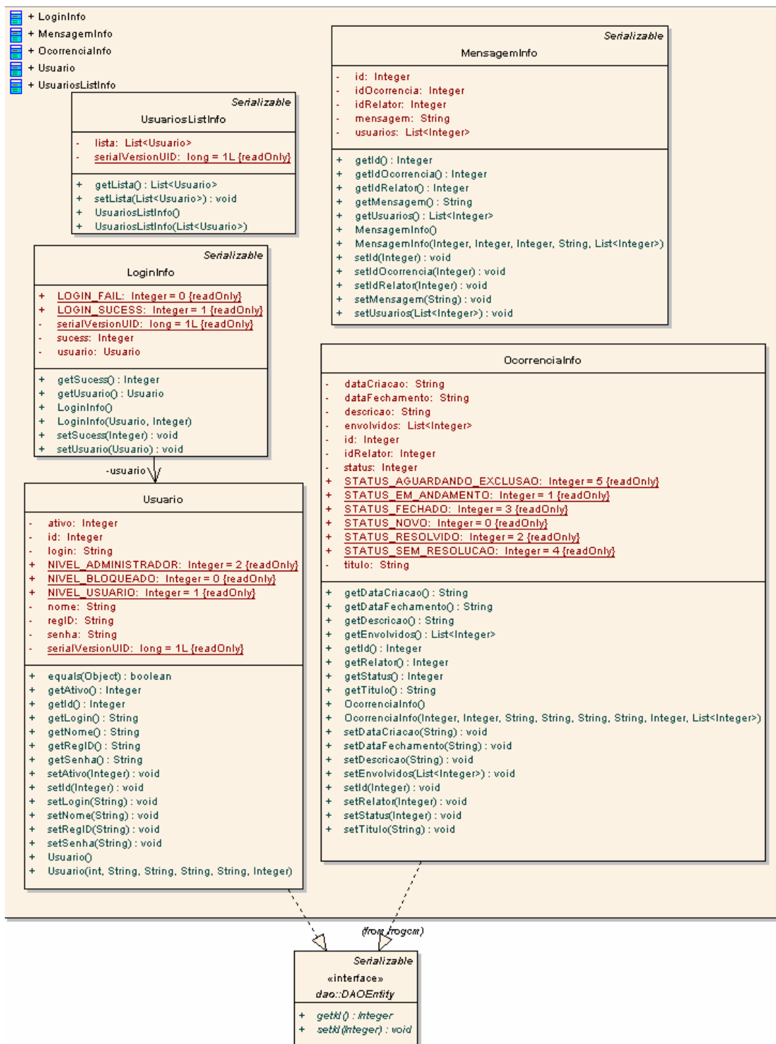
Figura 23 – Diagrama de Classes do pacote br.com.brantur.rrogcm.model da aplicação servidor
