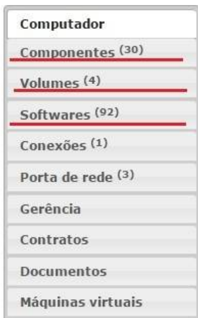
Figura 19 – Painel de opções importadas do FusionInventory no GLPI
