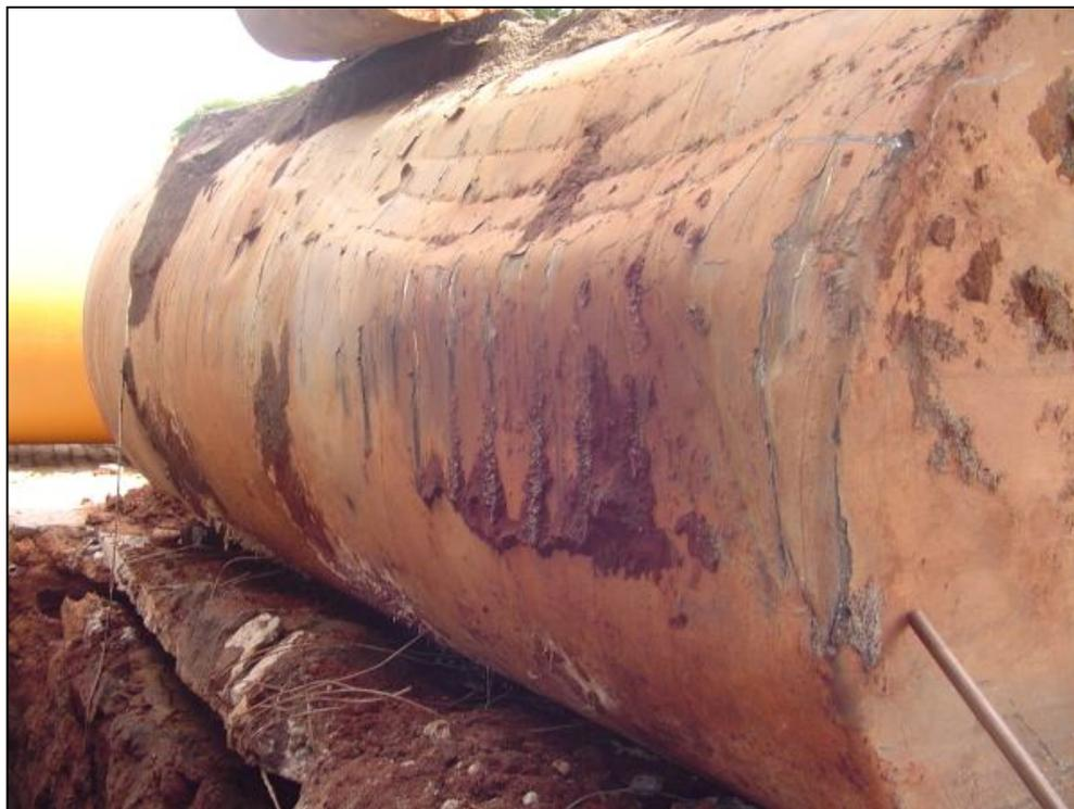
**Figura 12 – Tanque danificado por corrosão.**
