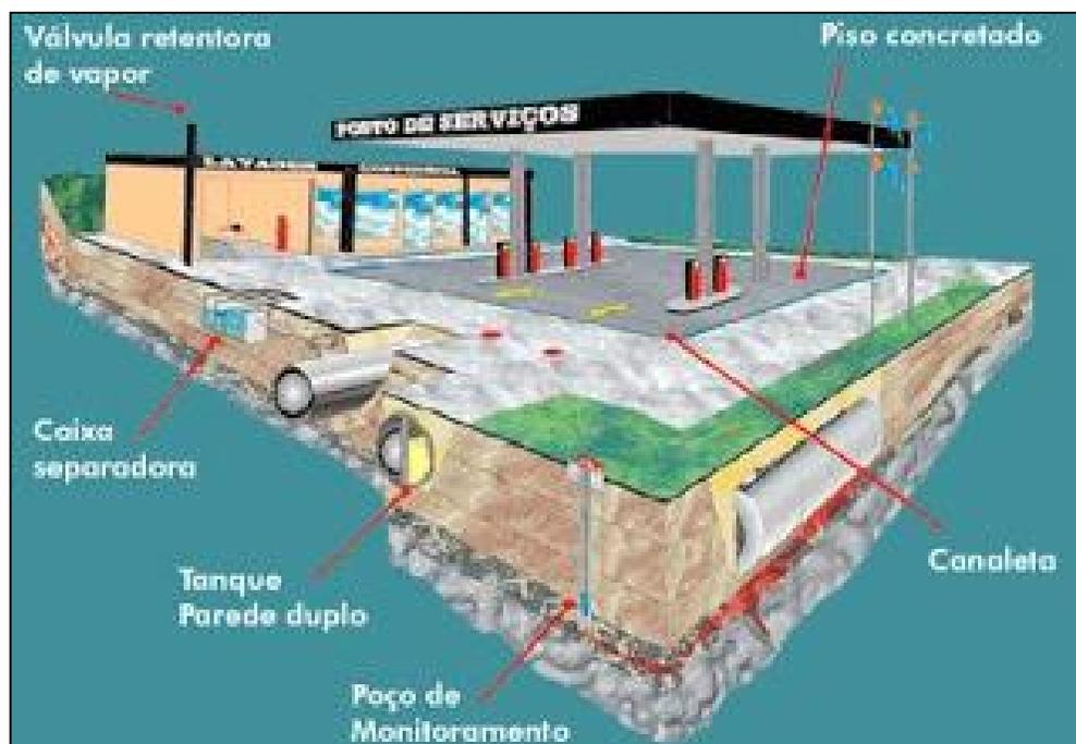
**Figura 14 – Exemplo de Posto de Combustível em Conformidade com as Exigências da CETESB.**
