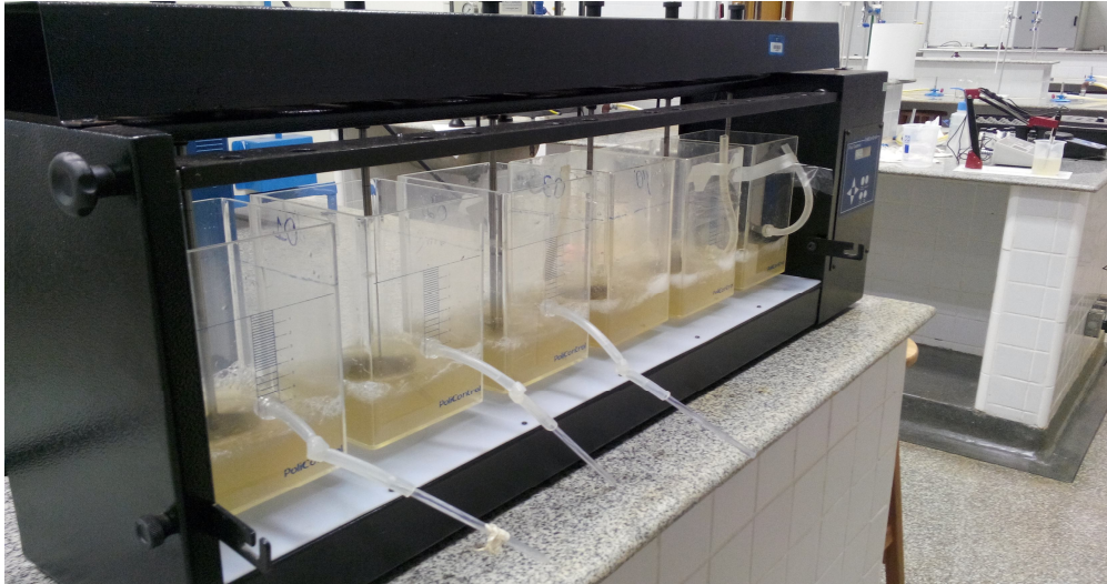
Figura 1. Procedimento de jar test com dosagem de coagulante orgânico em efluente.
